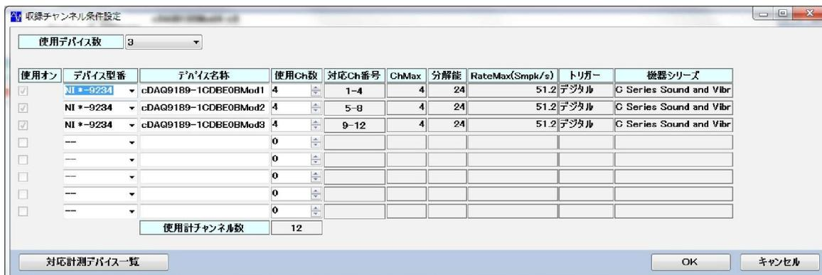
デバイス型番、およびデバイス名称は初期状態で、適切に設定されています。デバイス名称は、ナショナルインスツルメンツ社のDAQ管理ソフトMAXで確認できます。
