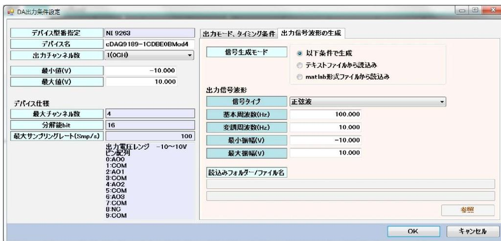
出力チャンネル数は1（0チャンネルのみ選択）で、正弦波生成を選択し、OKボタンを押します。
